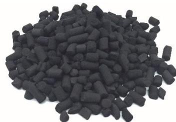
1. Adsorbimento fisico: *CLAROCAR* è costituito da una serie di macropori, mesopori e micropori; all'interno dei micropori avviene l'intrappolamento delle molecole inquinanti.
